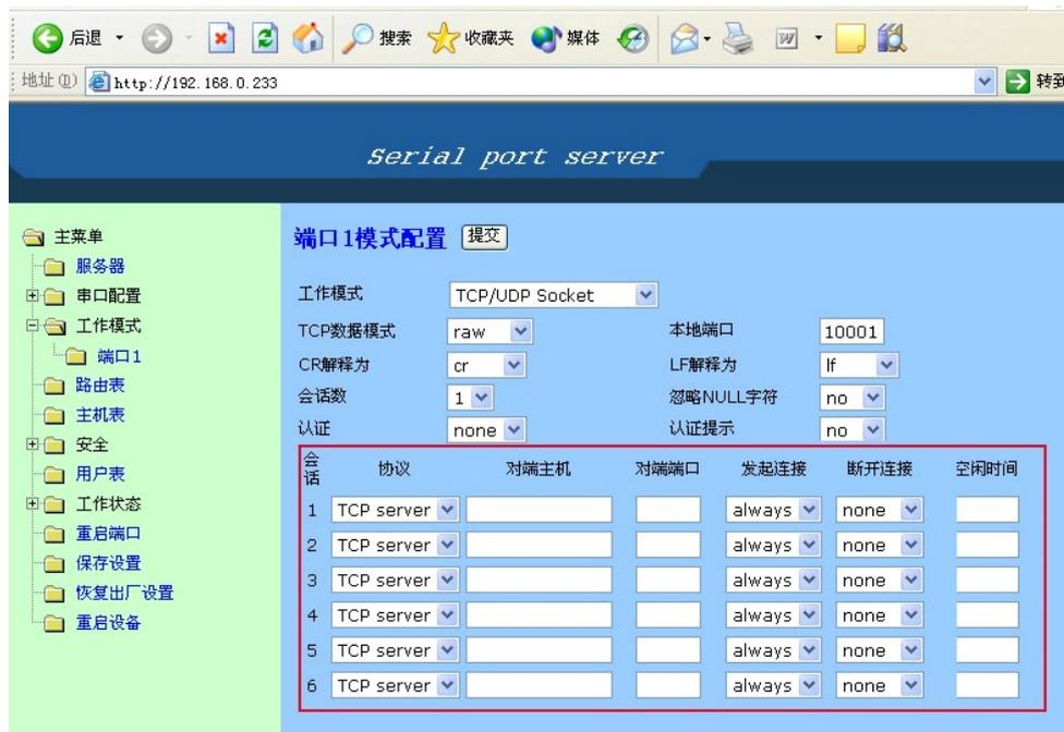
Socket 协议是 TCP/UDP 协议族中的一个重要应用领域，如果想建立一个快速的传输您可以选择 TCP/UDP Socket 工作模式，在这里您需要设置 TCP 的数据传输模式以及通过哪些端口等信息，需要注意的是，当您选择 TCP server 或者 TCP client 这两种不同的工作方式时要确保（详细参数）的正确设定，以便您的终端能够顺利的与建立连接。
