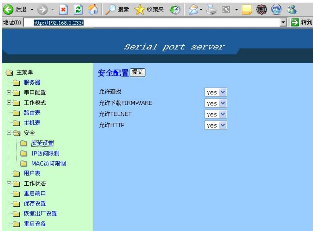
允许下载 Firmware: 指是否允许下载服务器升级程序 firmware，您可以打开“upgrade.exe”，点击 Tools 菜单下选择 Upgrade firmware 选项，upgrade 就会自动下载终端的固件升级程序，在默认情况下，服务器是支持下载的，如果您需要可以选择关闭允许项。
