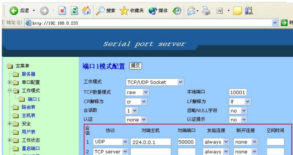
会话“协议”：“UDP”；“对端主机”：“224.0.0.1”组播地址；“对端口”：对端设备（串口服务器 B/C/D/E）“本地端口”；
