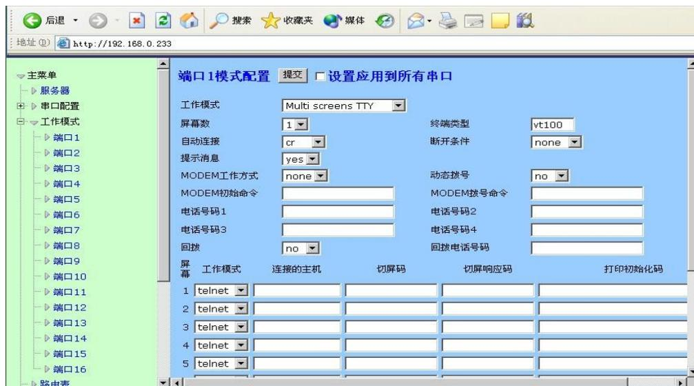
本系列串口服务器可以支持不同主机操作系统的切换，用户如果有两台以上不同操作系统的服务器主机，通过本系列串口服务器利用终端机同时登陆不同操作系统的主机，那么您可以在这里选择1—6的屏幕数。
