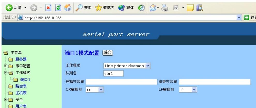
在 Line printer daemon 模式下您需要配置打印时的开始和结束字符串以便服务器按照您的需要正常工作。
