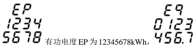
有功电度 EP 为 12345678kWh，无功电能 EQ 为 123456.7kvarh
