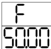
如图所示界面，显示为频率 F (单位 Hz)。显示数值为 50Hz。
