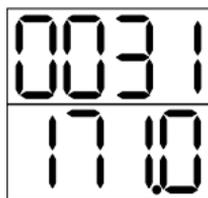
如图所示界面，显示为有功电度 EP(单位 kWh)。显示数值为 31171.0kWh。
