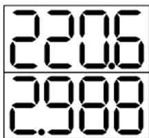
如图所示界面，显示为电压 V(单位 V)、电流 I (单位 A)。显示数值为 220.6V 电压，2.988A 电流。
